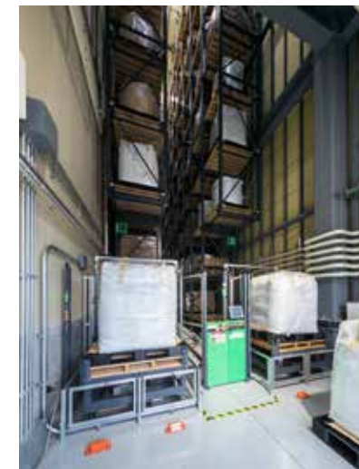
自動立体倉庫
